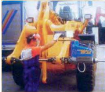
Retificação e soldadura interior do braço de uma retroescavadora.
